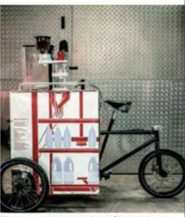
Es una máquina de café móvil, que funciona a pedal.
